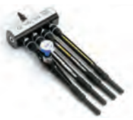
Адаптер с импактором подключен к Dräger AeroTest Simultan
