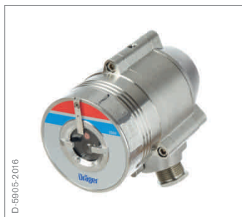
Dräger Flame 2350 Извещатель пламени Dräger Flame 2350 работает в двух диапазонах спектра. Он снабжен комбинацией УФ- и ИК-сенсоров, которые измеряют интенсивность излучения в двух диапазонах: УФ (0,185 - 0,260 мкм) и ИК (4,4 - 4,6 мкм).
